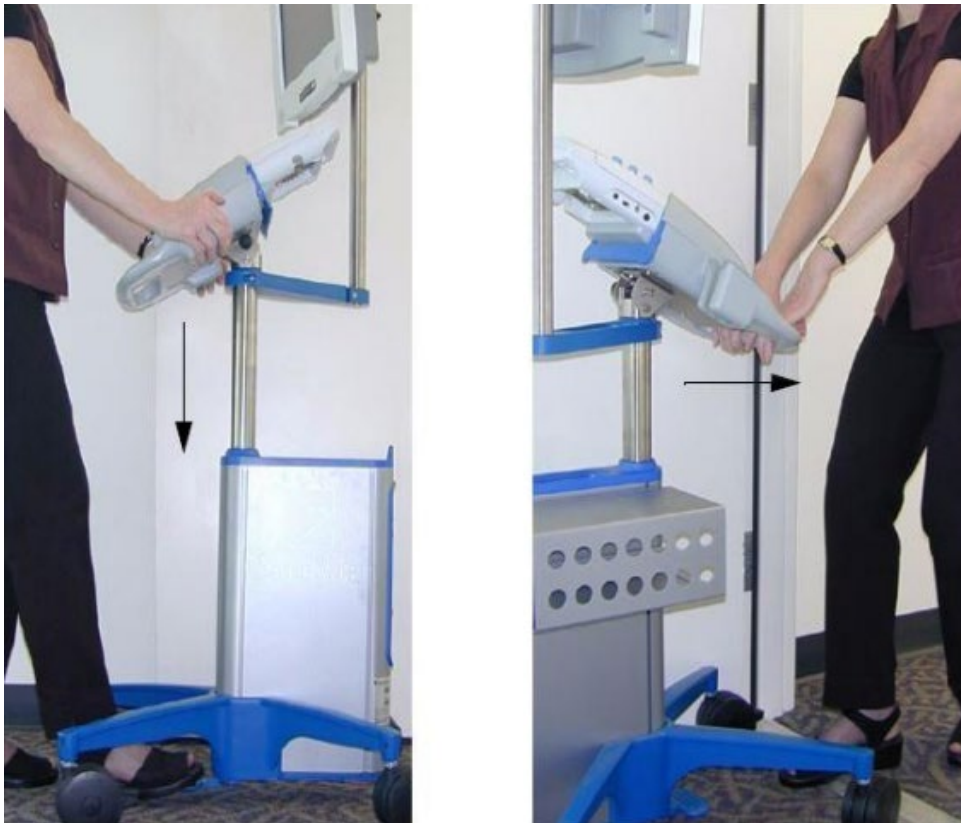
Şəkil 1.34. Hərəkətli hissələrin yoxlanılması
