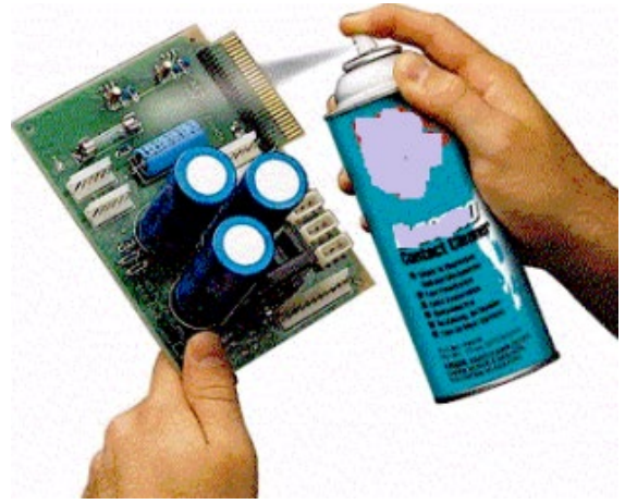
Şəkil 2.3. Elektron dövrənin təmizlənməsi
